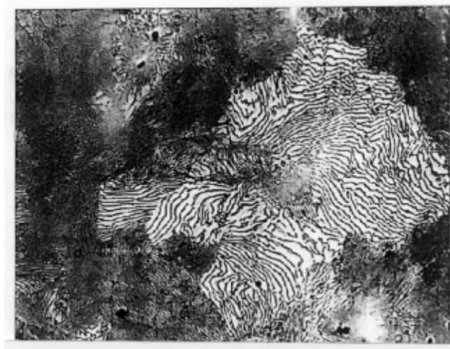
شکل 5 پرلیت در فولاد پر کربن (بزرگنمایی 550 برابر)
